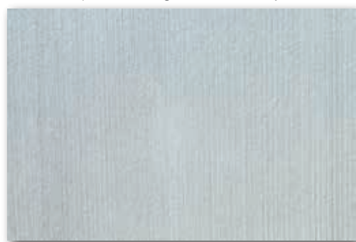
Aspect : béton gris, finition balayé
