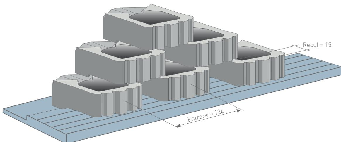
Système autodrainant : l'évidement permet un remplissage de terre ou autres matériaux.
