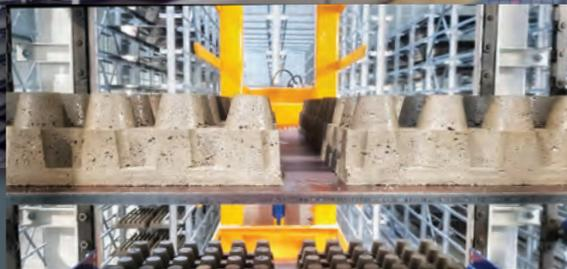
Îlot robotisé multifonction pour bordures en béton. (Alimentation grenailleuse, reprise sortie grenailleuse, évacuation des produits non conforme et palettisation).
