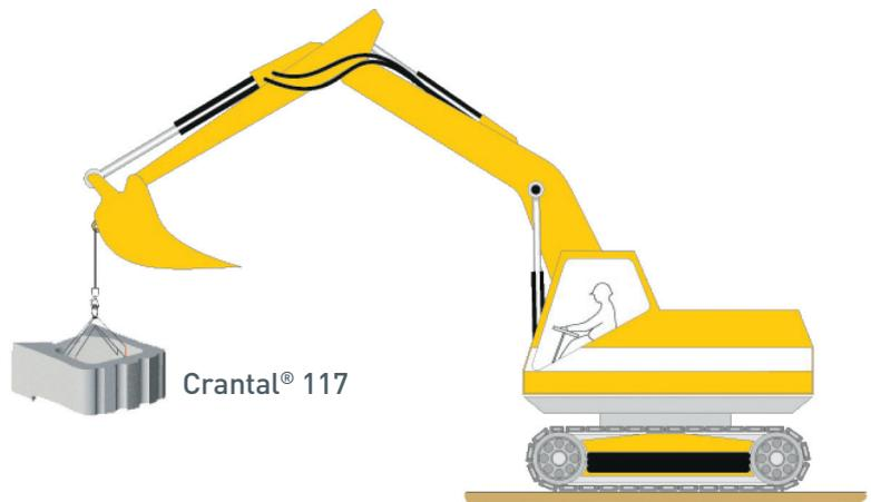
Avec cette configuration, et en fonction des conditions particulières du chantier, on peut prévoir une cadence de pose d'environ 100 à 150 éléments par jour.
