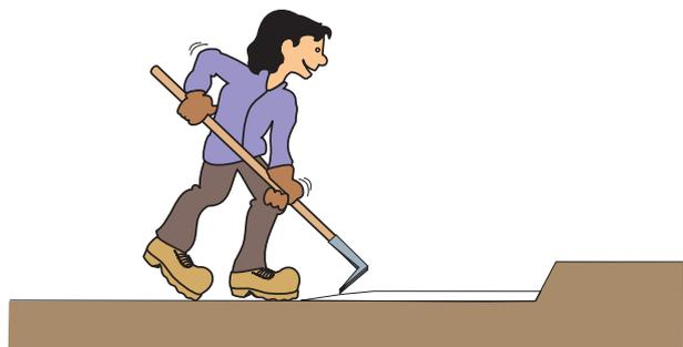
Mettre en oeuvre un lit de sable sur 2 à 3 cm avec du sable 0/4 ou 0/5.
